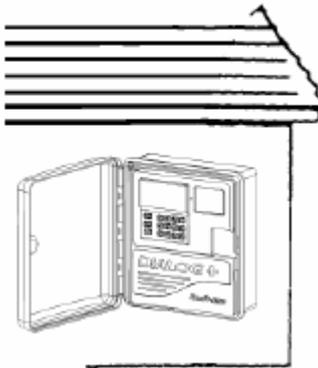
Расположите программатор вблизи источника питания 230 В, 50 герц. Программатор должен быть подсоединен к источнику электропитания, который соответствует стандартам и защищен предохранителями на электрической панели. Выбирайте место расположения в укрытии, чтобы на прибор не попадала вода.
